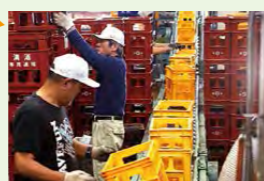
びんの入っていた P 箱は別のラインで洗浄されます。
