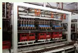
洗上がったびんは何度も検査され、P 箱に入られます。
